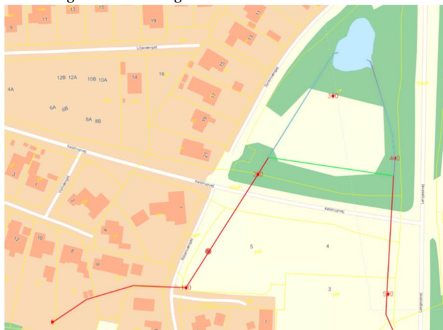
Kort 1. Skallebøllefløbet ved Kelstrupvej (rød streg). Grøn streg: ny rørledning. Blå streg: rørledning nedlægges.
