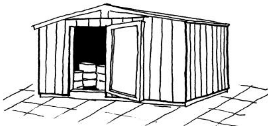
Figur 4 Et lukket skur med tæt befæstet gulv og opkant.
