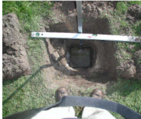
Hvis synkehastigheden ikke er næsten ens ved 2 målinger, fortsættes vandmætningen til der opnås næsten konstant synkehastighed.
