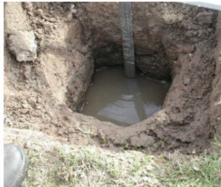
Synkehastigheden omregnes til m/s. Herefter kan testen afsluttes, og hullet tildækkes.
