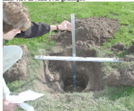
Der lægges en retskinne over hullet, og herfra måles nedstik til vandoverfladen.
