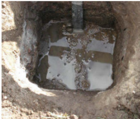
Nu starter den egentlige måling. Hullet fyldes med vand. Der måles, hvor langt ned vandet synker i en given tidsperiode (fx 10 min.).
